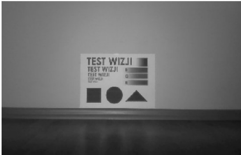
Rysunek 2.2: Obraz wykonany przy pomocy kamery zamontowanej w robocie. 320 \times 200 pikseli w odcieniach szarości [1]
