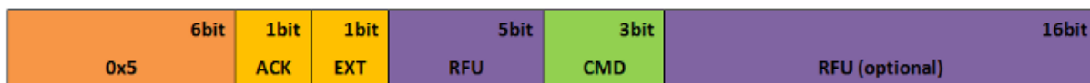
Rysunek A.5: Schemat ramki odpowiedzialnej za obsługę nagrywania i rekonstrukcji ścieżki powrotnej
