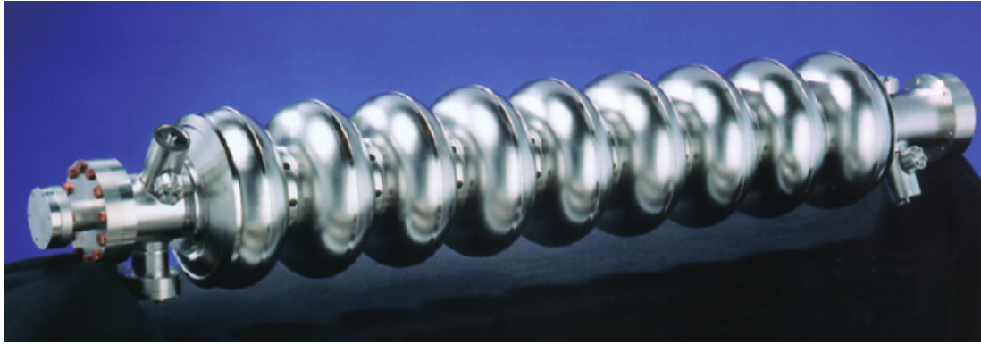
Rysunek 1.3: Widok ogólny niobowej, nadprzewodzącej wnęki rezonansowej o częstotliwości 1.3GHz [2].
