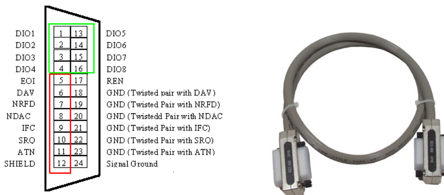
Rysunek 1.2. Z lewej: Schematyczny widok na przekrój przewodu. Z prawej: Przewód GP-IB
