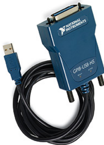
Rysunek 1.4. Kontroler GP-IB stosowany w laboratorium. Do komputera PC podłączany za pomocą portu USB.
