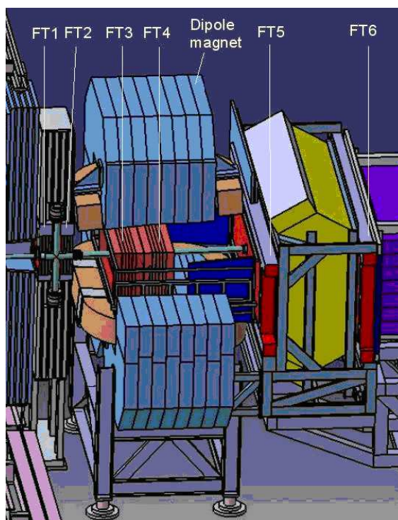
Rysunek 3.3: Schemat przedniego detektora śladu w eksperymencie \bar{P}ANDA [102].
