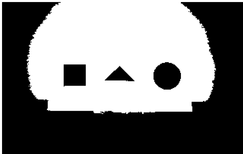
Rysunek 4.4: Obraz z rysunku 4.3 po przeprowadzonej segmentacji. Piksele „zapalone” zaznaczono kolorem czarnym.
