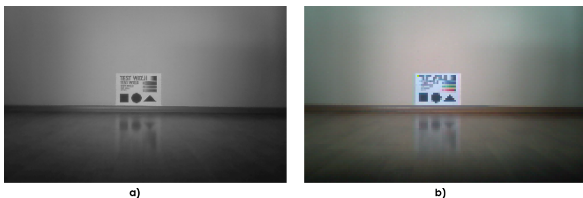
Rysunek 6.3: Obraz planszy testowej oddalonej o 2 metry od kamery robota. Rozdzielczość obrazu a) 320x200 pikseli, b) 160x100 pikseli.
